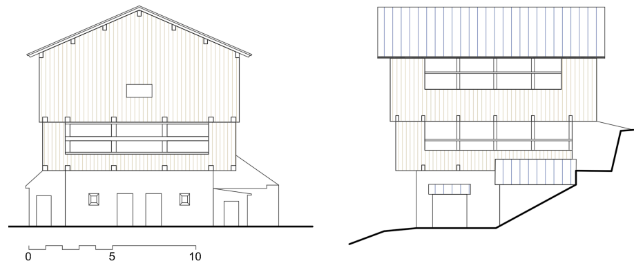
Fienile con ballatoio Prospetto del fronte rivolto a valle e prospetto laterale
