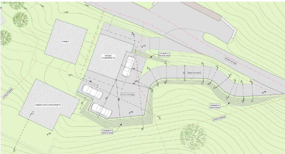
Planimetria comprendente il nuovo percorso e lo spazio di accesso e sosta.
